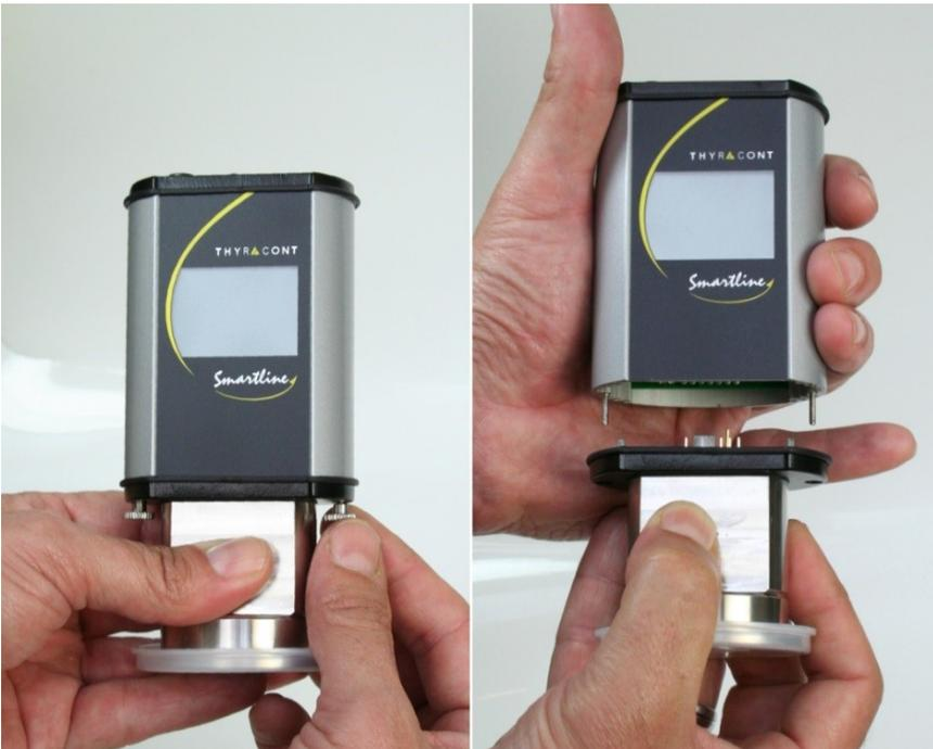
Stecken Sie nun den Ersatz-Sensorkopf (3) an die Elektronik-Einheit (5), achten Sie dabei auf korrekten Sitz der Profildichtung (4) am Gehäusedeckel. Sichern Sie die Rändelschrauben (1), Dichtscheiben (2) nicht vergessen.
