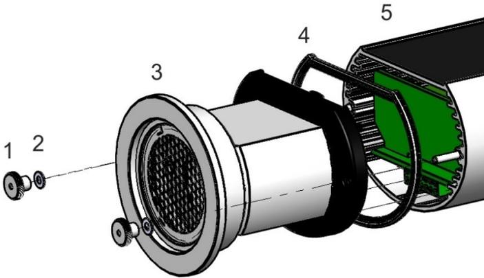
Lösen Sie die beiden Rändelschrauben (1) am unteren Deckel des Transmitters und ziehen Sie die Elektronik-Einheit (5) gerade und ohne Drehbewegung nach hinten vom Sensorkopf (3) ab. Achten Sie hierbei auf die Dichtscheiben (2).
