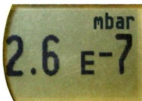
Zum Ändern der Anzeigeeinheit (mbar, Torr, hPa) während die Spannungsversorgung angeschlossen wird die »Adj« Taste gedrückt halten bis die Anzeige »Unit« erscheint. Dann die gewünschte Einheit durch Drücken der »Adj« Taste auswählen. Nach 5 s ohne weiteren Tastendruck wird die Einstellung gespeichert!
