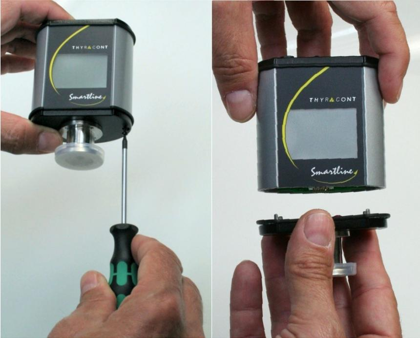
Stecken Sie nun den Ersatz-Sensorkopf an die Elektronik-Einheit an, achten Sie dabei auf korrekten Sitz der Profildichtung am Gehäusedeckel. Befestigen Sie den Sensor mithilfe der Torx-Schrauben.
